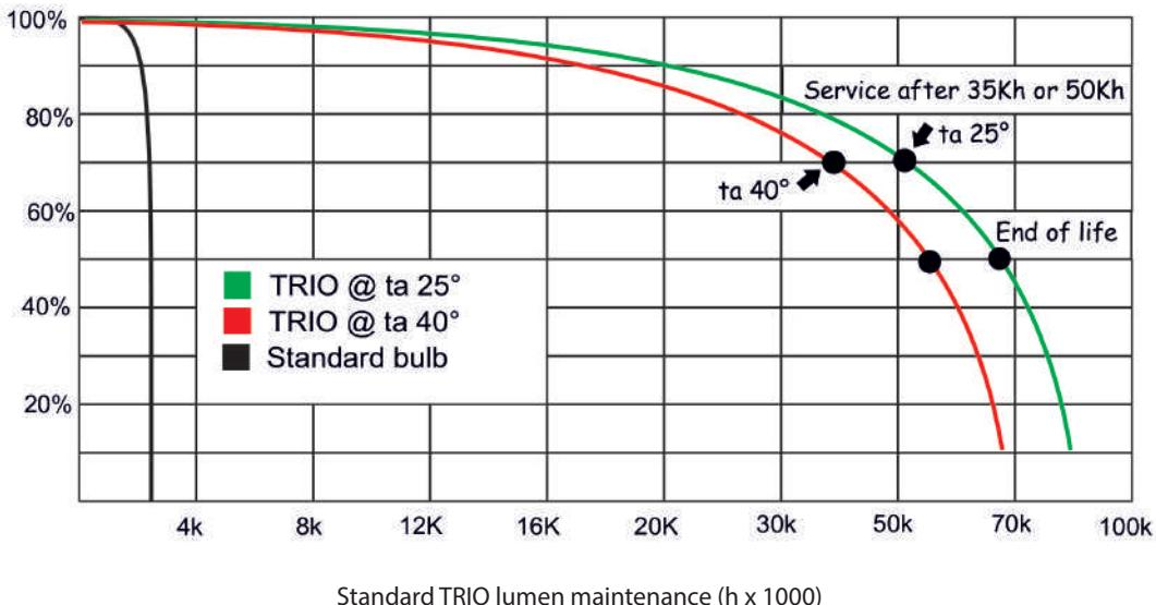
La durata di vita è uno dei vantaggi dei LED di potenza. Essi sono dei semiconduttori, quindi potenzialmente hanno una vita infinita o quasi. In realtà nel fabbricare questi componenti si utilizzano delle sostanze chimiche che nel tempo perdono di efficienza.
